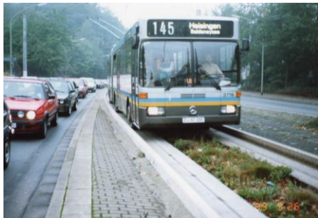
写真① 都心近郊に入ると「トロリー&ガイドウェイバス」になる。集電用のポールが見える。
